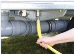
Einfacher Bajonettanschluss für die Frischwasserzufuhr
