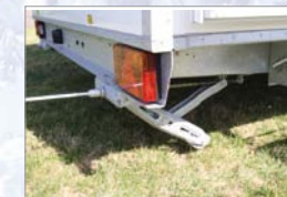
Ausfahrbare Stützen sorgen für einen festen Stand
