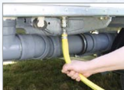
Einfacher Bajonettanschluss für die Frischwasserzufuhr
